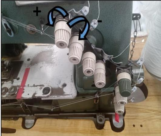
Debemos de saber que para obtener una costura perfecta en la maquina multiagujas, debe de estar perfectamente ajustada la tensión dependiendo del tipo del hilo que estemos usando en la maquina se ajustara la tensión y le daremos la tensión necesaria girando la perilla de tensión de los platillos, hacia la izquierda para aumentarla y para disminuirla para la derecha debemos de tomar en cuenta que entre más grueso el hilo menos tensión debe de llevar y en caso de tener hilo
