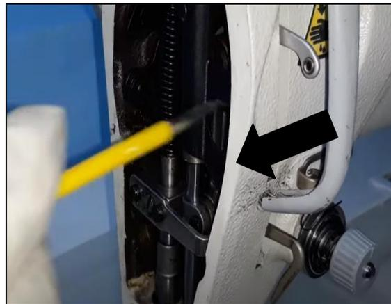
**12.3** Periódicamente ajustaremos los diferentes tornillos de los mecanismos de la máquina, para evitar que las piezas se muevan de su posición.
